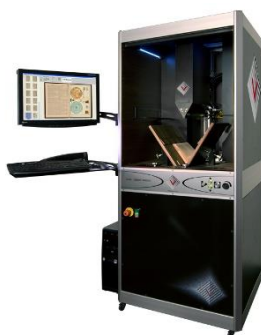
Фигура 1. ScanRobot® - за дигитализация на масиви от книги
